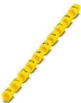
Segnafilo, giallo, diametro cavi: 1,4 ... 2,5 mm, longitudinale: Numeri, tipo di montaggio: infilamento, altezza del campo di testo: 2,6 mm, larghezza del campo di testo: 3,2 mm
