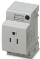
Presa di corrente, per Stati Uniti e altri paesi, Piano d'inserimento tipo AB 15A, tipo di connessione: Connessione a vite, colore: grigio, tensione nominale: 125 V AC (60 Hz), corrente nominale: 15 A, per montaggio su guida di montaggio nell'interfaccia di servizio o per montaggio diretto, norme/disposizioni: UL 508, Contrassegno del paese: USA
