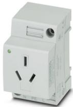
Presa di corrente, con LED, Piano d'inserimento tipo I, tipo di connessione: Connessione a vite, colore: grigio, tensione nominale: 250 V AC (50 Hz), corrente nominale: 10 A, per montaggio su guida di montaggio nell'interfaccia di servizio o per montaggio diretto, norme/disposizioni: GB 2099.1 e GB 1002, Contrassegno del paese: Cina
