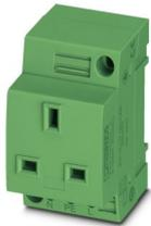
Presa di corrente, con protezione da contatto diretto estesa / shutter, spia luminosa, Piano d'inserimento tipo G, tipo di connessione: Connessione a vite, colore: verde, tensione nominale: 250 V AC (50 Hz), corrente nominale: 13 A, per montaggio su guida di montaggio nell'interfaccia di servizio o per montaggio diretto, norme/disposizioni: BS 1363-2, Contrassegno del paese: Gran Bretagna
