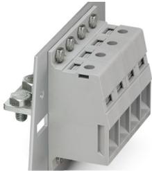
Morsetto d'esecuzione, tipo di connessione: Connessione a vite con gabbia, Attacco capocorda, numero poli: 1, corrente di carico: 232 A, sezione: 35 mm<sup>2</sup> - 95 mm<sup>2</sup>, direzione di connessione del conduttore alla direzione di inserzione: 0 °, larghezza: 25 mm, colore: verde-giallo
