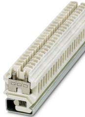
Morsettiera passante, tipo di connessione: connessione a vite, sezione: 0,5 mm<sup>2</sup> - 10 mm<sup>2</sup>, AWG 20 - 8, larghezza: 8,4 mm, colore: bianco, tipo di montaggio: NS 32, materiale isolante: ceramica
