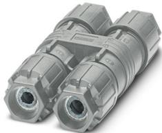
Distributore a H, tipo di connessione: Connessione IDC, numero poli: 4, 1 mm<sup>2</sup> ... 2,5 mm<sup>2</sup>, 690 V, 20 A, PA, grigio, con dado QUICKON, codifica: Profilo di codifica, diametro esterno conduttore: 6 mm ... 10 mm
