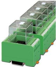
Modulo relè, con zoccolo a innesto per KAMMRELAIS ® grandezza 2, contatto: B 110, 4 contatti di scambio, tensione d'ingresso 220 V DC, con LED, diodo di smorzamento e di protezione contro l'inversione di polarità
