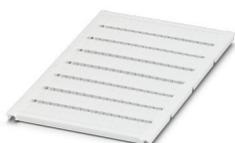
Segnamorsetti, Scheda, bianco, in bianco, siglabile con: BLUEMARK ID COLOR, BLUEMARK ID, BLUEMARK CLED, PLOTMARK, CMS-P1-PLOTTER, tipo di montaggio: fissare, per morsetti con spessore: 4,2 mm, dimensioni campo di siglatura: 3,6 x 10,5 mm, Numero dei cartellini singoli: 120
