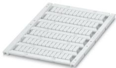
Segnamorsetti, Scheda, bianco, in bianco, siglabile con: TOPMARK NEO, TOPMARK LASER, BLUEMARK ID COLOR, BLUEMARK ID, BLUEMARK CLED, THERMOMARK PRIME, THERMOMARK CARD 2.0, THERMOMARK CARD, tipo di montaggio: fissare, per morsetti con spessore: 4,2 mm, dimensioni campo di siglatura: 3,6 x 10,5 mm, Numero dei cartellini singoli: 84
