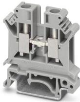
Morsetto passante, tensione nominale: 800 V, corrente nominale: 41 A, numero di connessioni: 2, tipo di connessione: Connessione a vite, Sezione di dimensionamento: 6 mm<sup>2</sup>, sezione: 0,2 mm<sup>2</sup> - 10 mm<sup>2</sup>, tipo di montaggio: NS 35/7,5, NS 35/15, NS 32, colore: grigio
