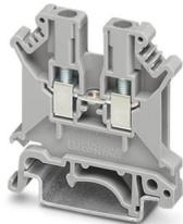
Morsetto passante, tensione nominale: 800 V, corrente nominale: 24 A, numero di connessioni: 2, tipo di connessione: Connessione a vite, Sezione di dimensionamento: 2,5 mm<sup>2</sup>, sezione: 0,2 mm<sup>2</sup> - 4 mm<sup>2</sup>, tipo di montaggio: NS 32, NS 35/15, NS 35/7,5, colore: grigio
