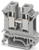
Morsetto passante, tensione nominale: 800 V, corrente nominale: 57 A, numero di connessioni: 2, tipo di connessione: Connessione a vite, Sezione di dimensionamento: 10 mm<sup>2</sup>, sezione: 0,5 mm<sup>2</sup> - 16 mm<sup>2</sup>, tipo di montaggio: NS 35/7,5, NS 35/15, NS 32, colore: grigio
