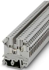
Morsetto passante, tensione nominale: 500 V, corrente nominale: 32 A, numero di connessioni: 3, tipo di connessione: Connessione a vite, Sezione di dimensionamento: 4 mm<sup>2</sup>, 1. piano, sezione: 0,2 mm<sup>2</sup> - 4 mm<sup>2</sup>, tipo di montaggio: NS 35/7,5, NS 35/15, NS 32, colore: grigio
