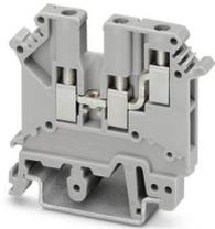
Morsetto passante, tensione nominale: 400 V, corrente nominale: 24 A, tipo di connessione: Connessione a vite, 1. piano, Sezione di dimensionamento: 2,5 mm<sup>2</sup>, sezione: 0,2 mm<sup>2</sup> - 2,5 mm<sup>2</sup>, tipo di montaggio: NS 35/7,5, NS 35/15, NS 32, colore: grigio
