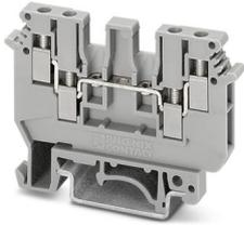
Morsetto passante, tensione nominale: 500 V, corrente nominale: 24 A, tipo di connessione: Connessione a vite, Sezione di dimensionamento: 2,5 mm<sup>2</sup>, sezione: 0,2 mm<sup>2</sup> - 4 mm<sup>2</sup>, tipo di montaggio: NS 35/7,5, NS 35/15, NS 32, colore: grigio
