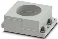
Isolatori passanti, grandi, numero dei conduttori: 1, esecuzione: Cavo a sezione circolare, intagliato, diametro esterno conduttore: 1x 28 mm ... 29 mm, materiale: SEBS (senza alogenati), colore: grigio, lunghezza: 53 mm, larghezza: 39 mm, altezza: 17 mm
