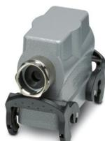
Custodia mobile HEAVYCON B16, con bloccaggio trasversale, altezza 72 mm, con connessione a vite 1x Pg21, uscita cavo laterale
