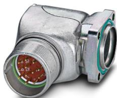
Connettore per apparecchi anteriore, angolato, fisso, Bloccaggio a vite, M23, numero poli: 17, tipo di connessione del contatto: Spina, O-ring assiale, 4x Ø 3,2, schermato: sì, misura flangia: 26 mm x 26 mm, numero poli: 17, tipo di connessione: Connessione a crimpare, serie: RF
