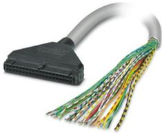
Cavo a sezione circolare intestato, schermato, senza alogeni; connessione 1: IDC/FLK conduttore femmina (1x 40-poli, 180 °-uscita); connessione 2: Fili singoli (40-poli); lunghezza cavo: 2 m
