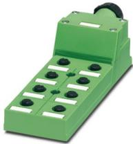
Scatola di distribuzione, tipo di connessione: Connettore femmina M12 Plastica, numero degli slot: 8, numero poli: 5, codifica: A, occupazione slot: doppi, segnalazione di stato: no, Universale; connessione linea principale: Morsetto a vite estraibile 180°, schermatura: no
