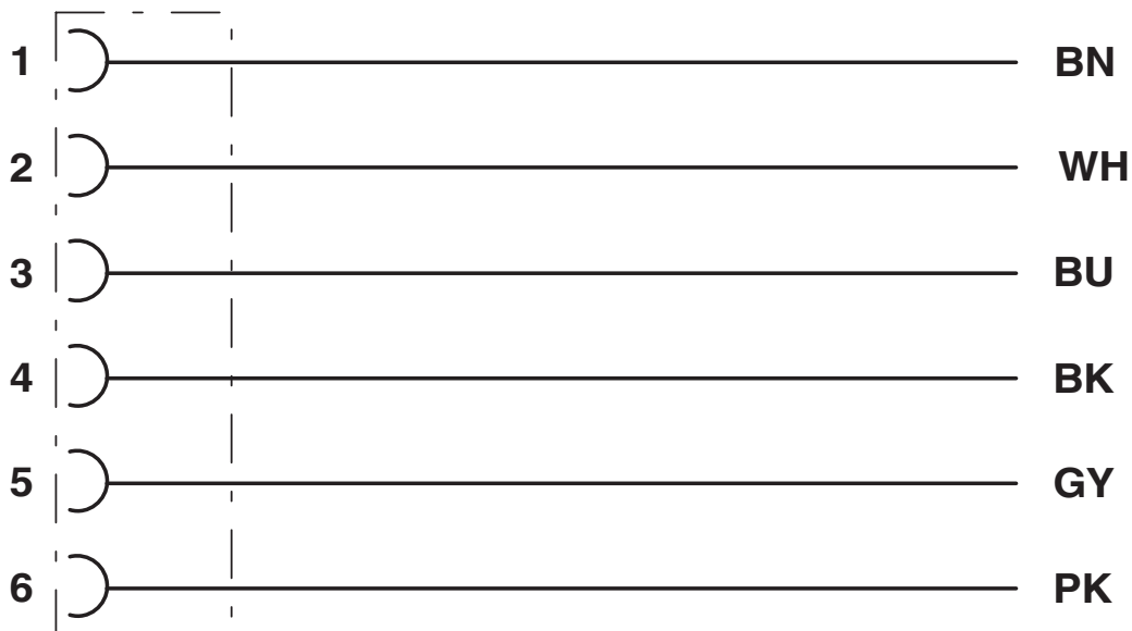
Affectation des contacts du connecteur femelle M8
