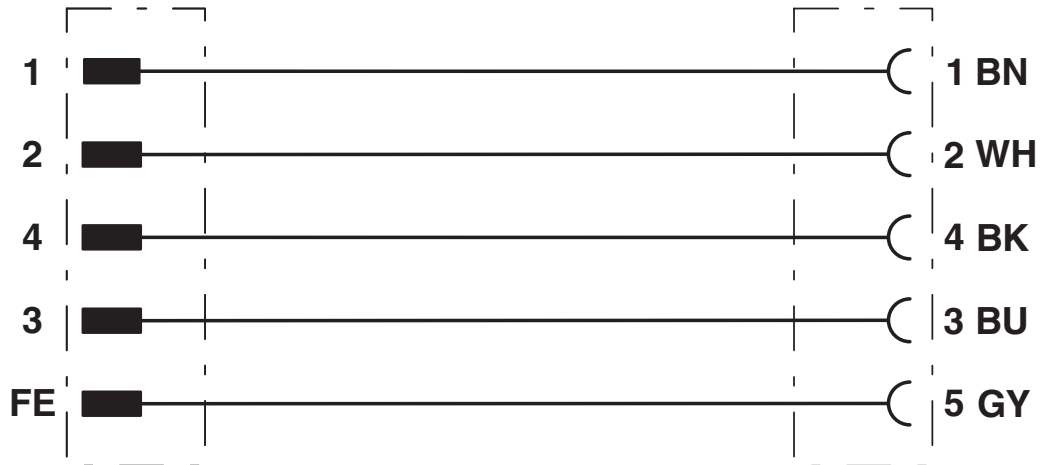
Disposition des contact des connecteurs mâle/femelle M12
