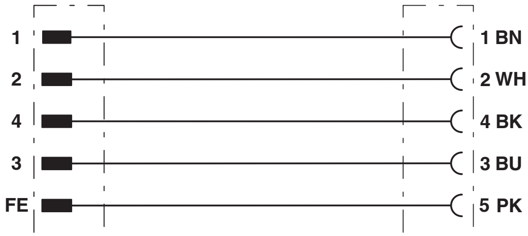
Schéma de connexion
