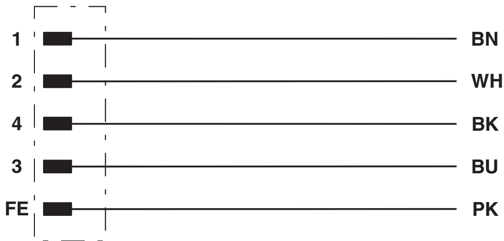
Affectation des contacts du connecteur mâle M12
