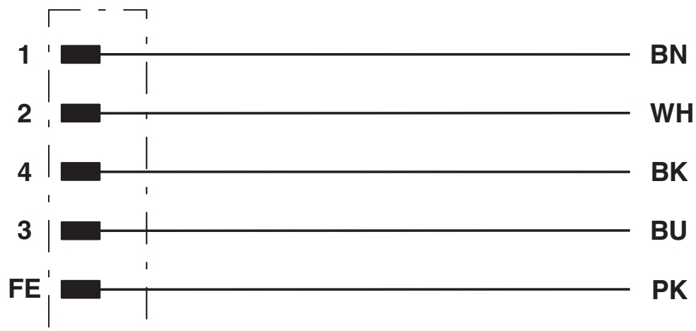
Affectation des contacts du connecteur mâle M12
