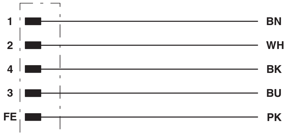
Affectation des contacts du connecteur mâle M12
