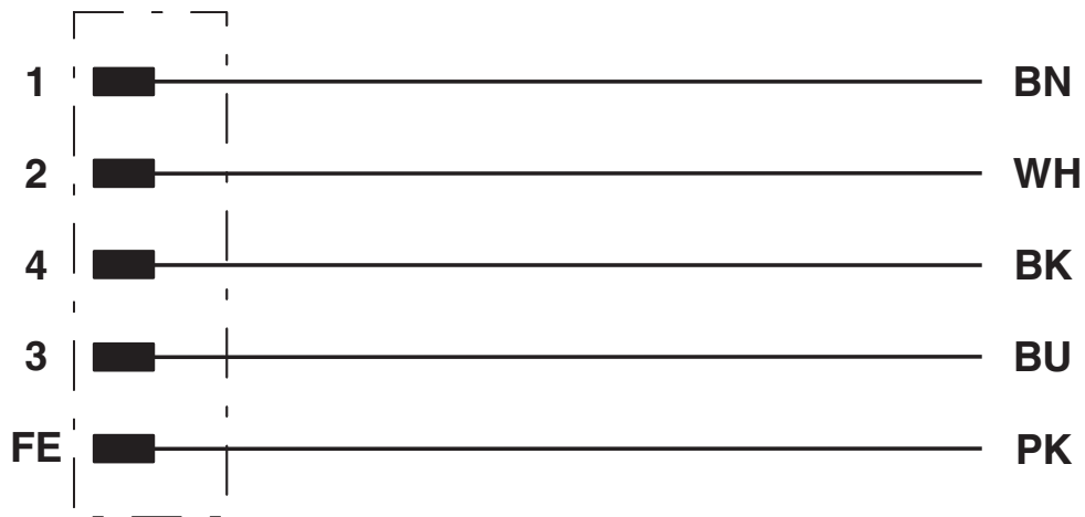
Affectation des contacts du connecteur mâle M12
