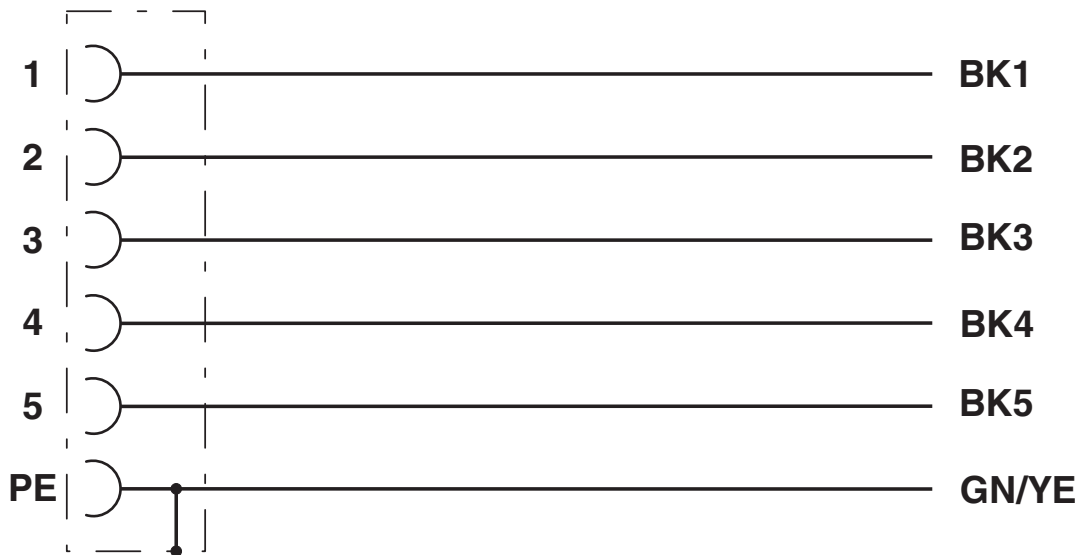
Affectation des contacts du connecteur femelle M12
