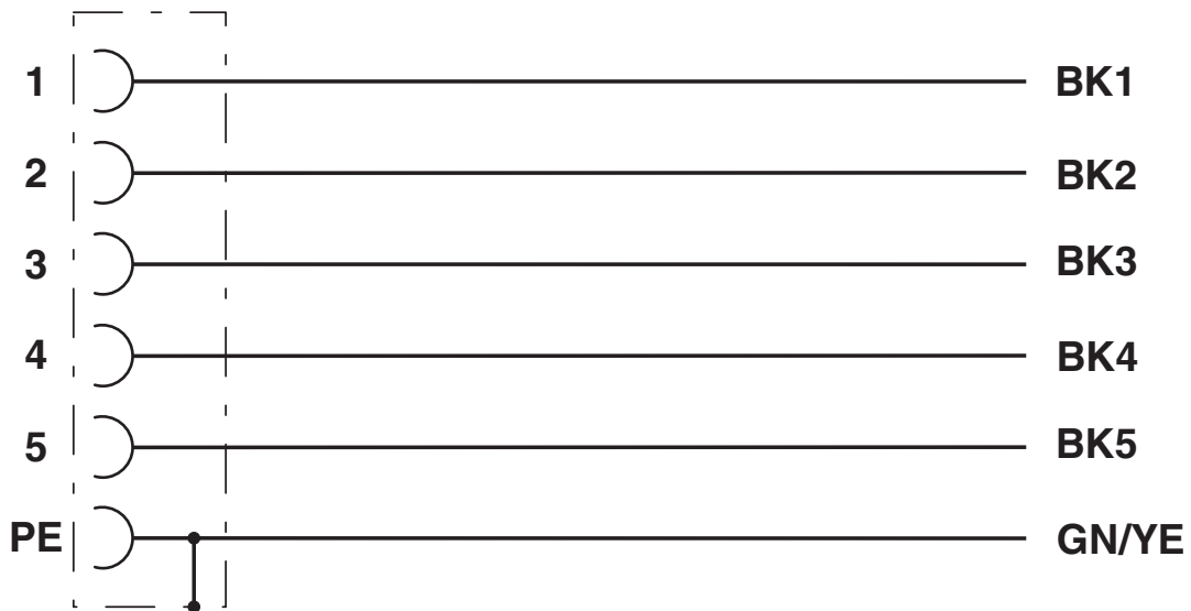
Affectation des contacts du connecteur femelle M12
