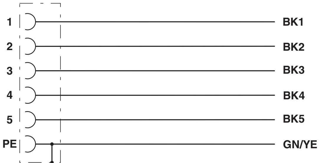
Affectation des contacts du connecteur femelle M12
