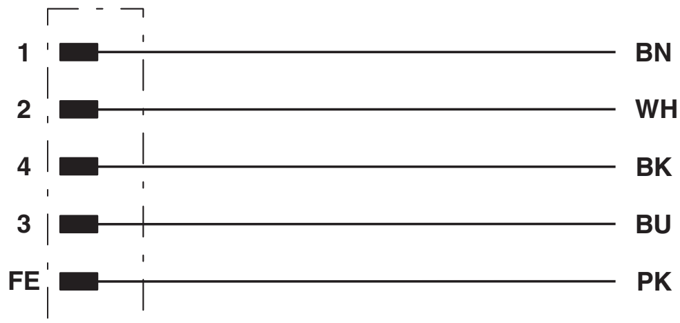
Affectation des contacts du connecteur mâle M12
