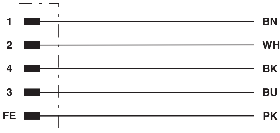
Affectation des contacts du connecteur mâle M12
