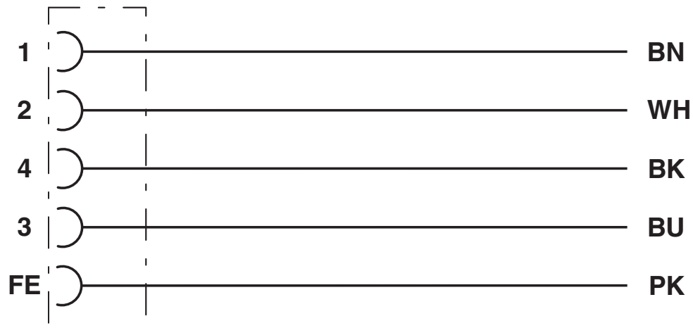
Affectation des contacts du connecteur femelle M12
