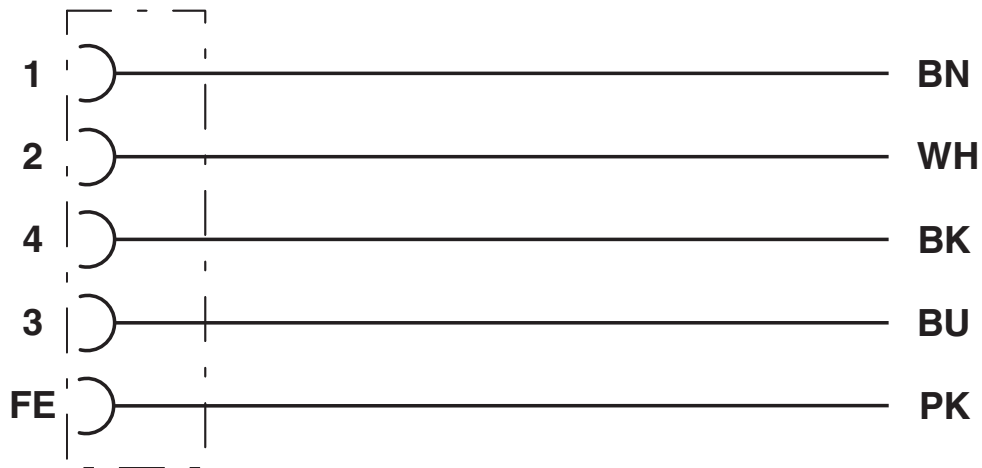
Affectation des contacts du connecteur femelle M12
