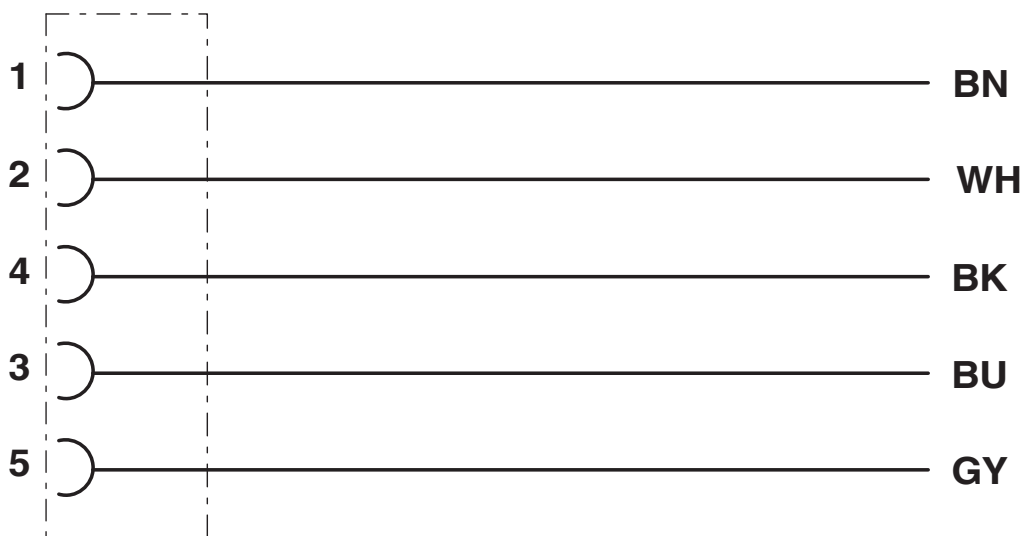
Affectation des contacts du connecteur femelle M12
