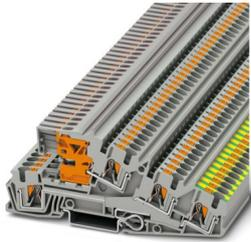
Borne de tierra para distribución, tensión nominal: 400 V, corriente nominal: 28 A, Conexión push-in, 1., 2. y 3er piso, Sección de dimensionamiento: 4 mm<sup>2</sup>, sección: 0,2 mm<sup>2</sup> - 6 mm<sup>2</sup>, Conexión push-in, clase de montaje: NS 35/7,5, NS 35/15, color: gris
