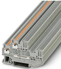
Borna de doble piso, La corriente y la tensión son determinadas por el conector empleado., tensión nominal: 500 V, corriente nominal: 16 A, tipo de conexión: Conexión push-in / conexión enchufable, 1er y 2º piso, Sección de dimensionamiento: 1,5 mm<sup>2</sup>, sección: 0,14 mm<sup>2</sup> - 1,5 mm<sup>2</sup>, clase de montaje: NS 35/7,5, NS 35/15, color: gris
