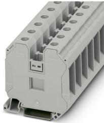
Borne de paso, tensión nominal: 1000 V, corriente nominal: 125 A, número de conexiones: 2, tipo de conexión: Conexión por tornillo, Sección de dimensionamiento: 35 mm<sup>2</sup>, sección: 1,5 mm<sup>2</sup> - 50 mm<sup>2</sup>, clase de montaje: NS 35/7,5, NS 35/15, color: gris
