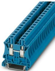
Borne de paso, tensión nominal: 1000 V, corriente nominal: 41 A, número de conexiones: 2, tipo de conexión: Conexión por tornillo, Sección de dimensionamiento: 6 mm<sup>2</sup>, sección: 0,2 mm<sup>2</sup> - 10 mm<sup>2</sup>, clase de montaje: NS 35/7,5, NS 35/15, color: azul
