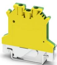
Borna de tierra, número de conexiones: 2, número de polos: 1, tipo de conexión: Conexión por tornillo, sección: 0,14 mm<sup>2</sup> - 1,5 mm<sup>2</sup>, tipo de sujeción: Pie PE con tornillo de fijación, M2, clase de montaje: NS 35/7,5, NS 35/15, NS 32, color: amarillo-verde
