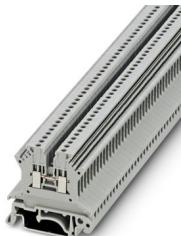
Borne de paso, tensión nominal: 500 V, corriente nominal: 17,5 A, número de conexiones: 2, tipo de conexión: Conexión por tornillo, Sección de dimensionamiento: 1,5 mm<sup>2</sup>, sección: 0,14 mm<sup>2</sup> - 1,5 mm<sup>2</sup>, clase de montaje: NS 35/7,5, NS 35/15, NS 32, color: gris
