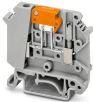
Borna interrumpible por cuchilla, con hembras roscadas para tomas de prueba para alojar clavijas de prueba, tensión nominal: 500 V, corriente nominal: 16 A, 1er piso, tipo de conexión: Conexión por tornillo, Sección de dimensionamiento: 2,5 mm<sup>2</sup>, sección: 0,2 mm<sup>2</sup> - 6 mm<sup>2</sup>, montaje: NS 35/7,5, NS 35/15, NS 32, color: gris
