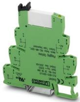
Interfaz PLC, compuesta por borne de base PLC-BSP.../21 con conexión por resorte y relé miniatura enchufable con contacto de potencia, para el montaje sobre carril NS 35/7,5, 1 contacto conmutado, tensión de entrada 48 V DC
