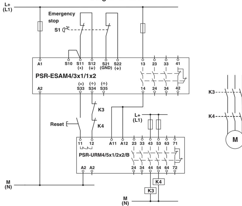
Conexión de un canal con integración del circuito de acuse de recibo y contactos monitorizados externamente
