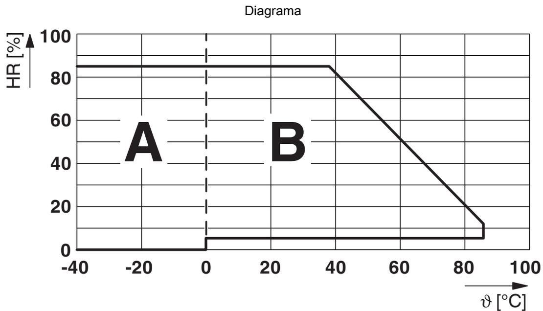
Humedad del aire admisible para el funcionamiento y el almacenamiento.
