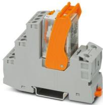
Módulo de relé premontado con conexión por tornillo, compuesto de: zócalo de relé, relé con contacto de potencia, módulo de indicación/antiparasitario enchufable y brida de sujeción. Tipo de conmutación del contacto: 4 conmutadores. Tensión de entrada: 24 V AC
