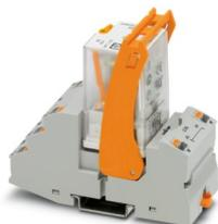
Módulo de relé premontado con conexión push-in, compuesto de: zócalo de relé, relé con contacto de potencia, módulo de indicación/antiparasitario enchufable y brida de sujeción. Tipo de conmutación del contacto: 2 conmutadores. Tensión de entrada: 230 V AC
