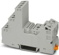
Zócalo de relé RIF-2..., para relés industriales con 2 o 4 contactos conmutados, conexión por tornillo, posibilidad de enchufe para módulos de entrada/antiparasitario, para montaje sobre carril NS 35/7,5
