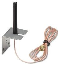
Antena omnidireccional para montaje en pared, banda de frecuencia: 2,4 GHz, ganancia: 2 dBi, índice de protección: IP65, conexión RSMA (macho), incl. cable de conexión de 1,5 m, soporte de montaje y material de montaje
