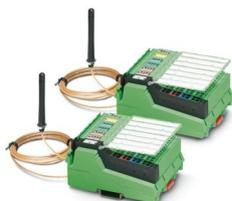
Juego Wireless MUX, dos módulos con 16 entradas y salidas digitales cada uno y 2 entradas y salidas analógicas (0 ... 20 mA, 0 ... 10 V), conexión de antena RSMA (hembra), incl. antenas omnidireccionales con cable de 1,5 m
