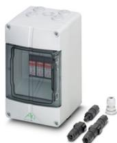
Protección contra sobretensiones en carcasa IP65 para instalaciones fotovoltaicas, varistores enchufables con dispositivo de desconexión térmica entre L+, L- y tierra/PE, conexión a través de macho / hembra multicontacto.
