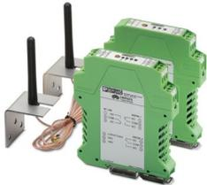
Sistema de transmisión unidireccional, inalámbrico, de 2.400 MHz, compuesto por un emisor (Transmitter, Tx) y un receptor (Receiver, Rx)
