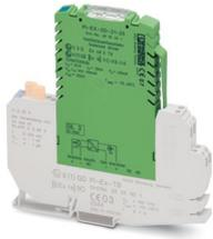
Bloque de control de válvulas Ex i, enchufable. Para la activación de válvulas magnéticas intrínsecamente seguras y de componentes de alarma instalados en la zona Ex, así como de aparatos eléctricos sencillos. Para gases del Grupo IIC, alimentado en bucle. Separación galvánica.
